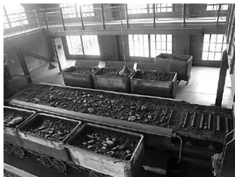
今も当時の姿のまま残る石炭を選別していたコンベアー
